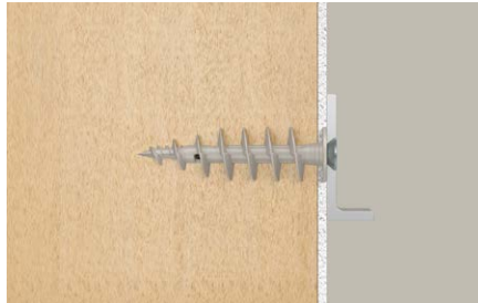
Applicazione su cappotto in Fibra di legno.
