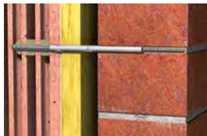
Dettaglio: Risanamento della muratura esterna
