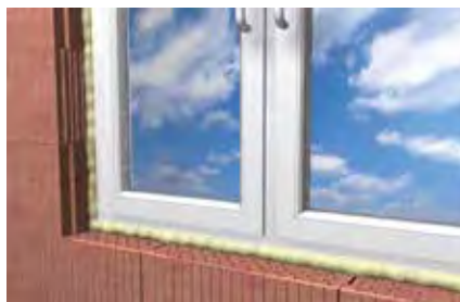
Giunti di connessione in serramenti
