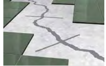
Sigillatura di fessure
